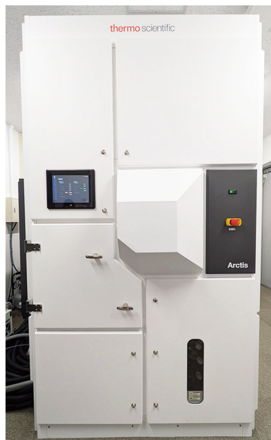
クライオ薄片作製装置 Arctis
