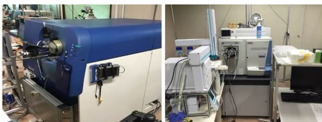
図2 ハイブリッド型質量分析計 左から TripleTOF5600、LTQ Orbitrap Velos Pro
