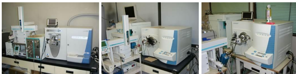
図2 イオントラップ型質量分析計 左からLTQ、LCQdeca、LCQdecaXP
