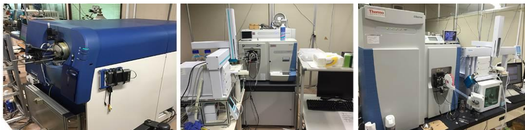
図3 ハイブリッド型質量分析計 左から TripleTOF5600、LTQ-Orbitrap Velos、Q Exactive
